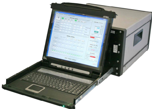
Fig. 1 - EGSE con console in posizione operativa
